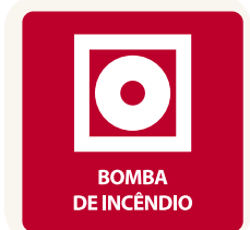
Comando manual de alarme/bomba de incêndio
