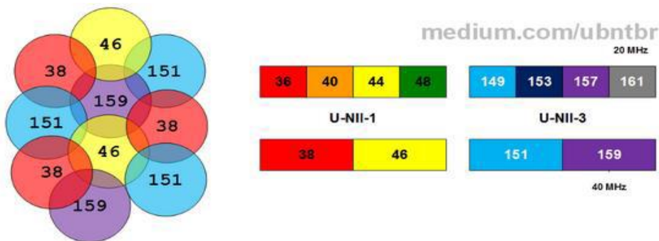
Figura 14 – Planejamento de Canais em 5 GHz e banda de 40MHz
