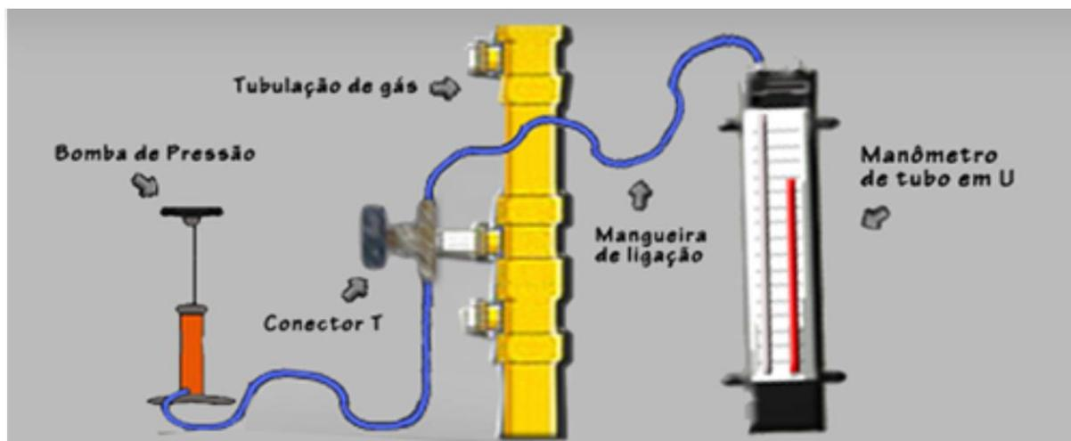
Ilustração do ensaio de teste de estanqueidade.
