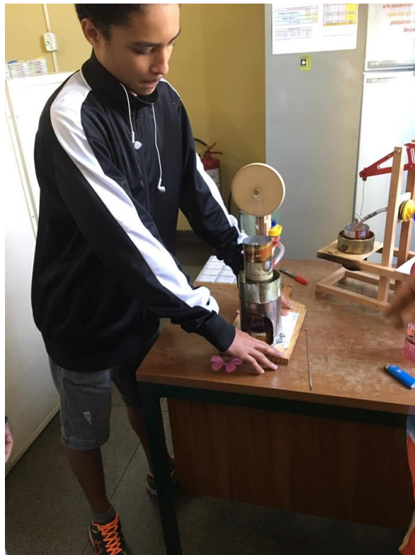
Figura 2 - Henrique, espantado com os giros do Motor de Stirling! Apenas uma chama com álcool em gel, e o uso de água gelada, e temos diferencial de temperatura capaz de mover o disco de madeira rapidamente!
