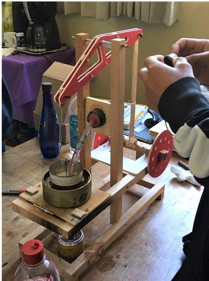
Figura 4 - Estrutura do Motor de Stirling. Não há materiais especiais: foi feito com o que há em casa...
