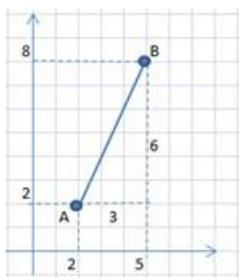
O valor do coeficiente angular “m” do segmento de reta nos pontos A (2,2) e B (5,8), conforme diagrama é  $m=2$ , pois da equação de reta  $y=mx+h$ , temos que:
