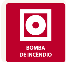
Comando manual de alarme/bomba de incêndio
