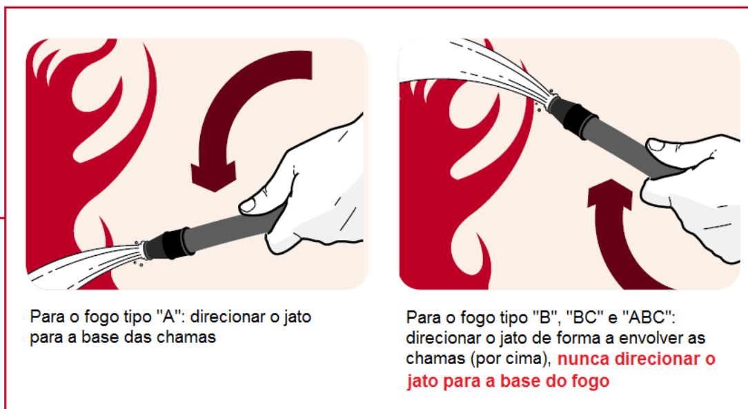
Figura 23 - Direcionamento do jato Fonte: FDE
