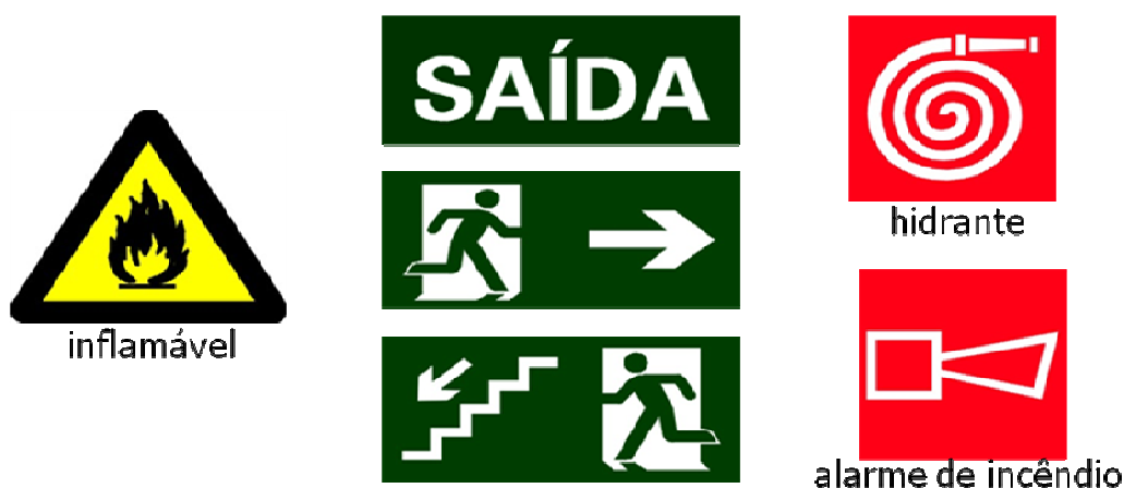
Figura 5 - Sinalização de segurança. Norma: IT-20 do CBPMESP Fonte: IT-20 – CBPMESP
