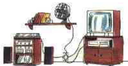
Figura 28 - Excesso de equipamentos na mesma tomada: perigo Fonte: DSCI - CBPMESP
