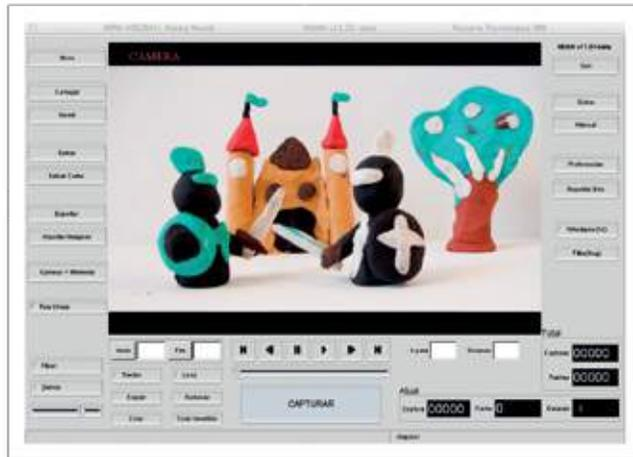
No painel do MUAN, destaca-se a grande tela que mostra as imagens que a câmera está transmitindo para o computador. Apertando-se o botão “capturar”, grava-se uma “foto” (imagem fixa) da imagem atual na memória digital (disco rígido ou pendrive).
