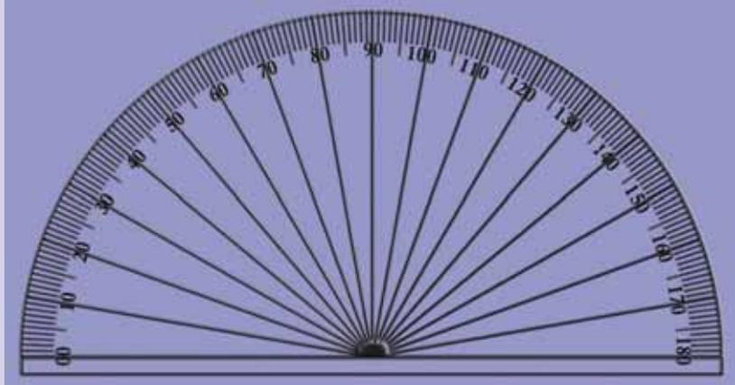
Observe que no centro do transferidor há um ponto. Esse ponto é o centro do ângulo. Alinhe o zero do transferidor com o 0° marcado no círculo acima. Depois marque o ângulo na direção do aumento da contagem do transferidor.
